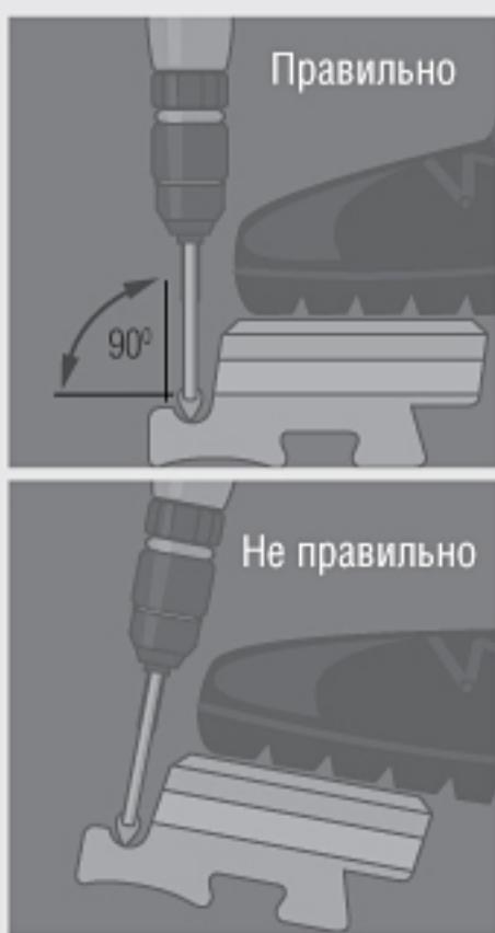
Сверление камня осуществляется на ровной поверхности, под углом 90° с помощью безударной дрели со сверлом по кафелю.
