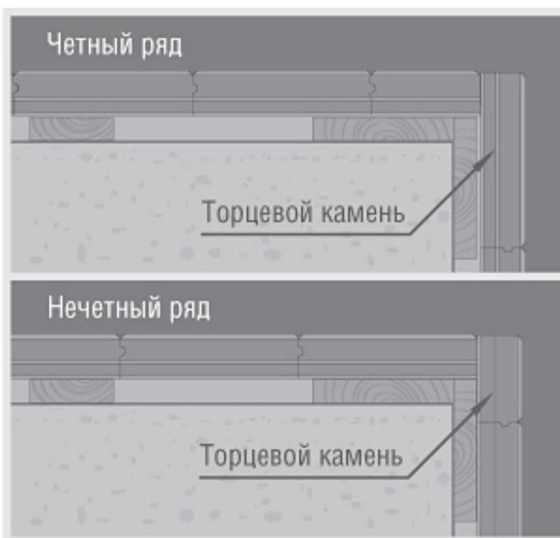
▼ Вариант устройства угла с применением торцевых камней.
